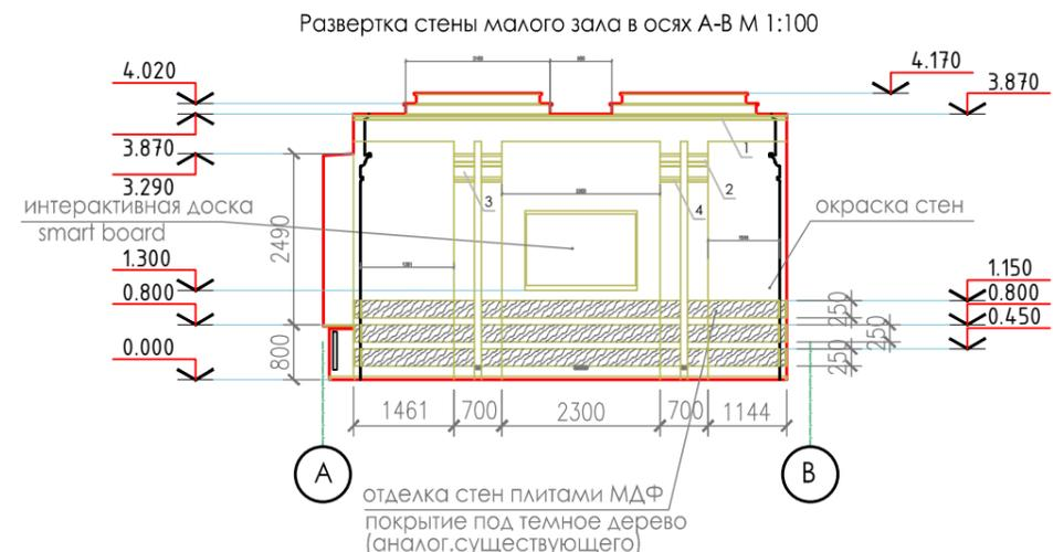
Площадь окрасочного покрытия стен (окраска-акриловая водоэмульсионная): 115.3 м2
